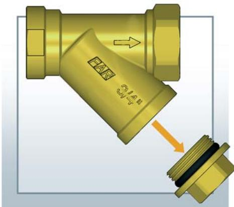
Svitare il tappo terminale con una chiave da 19mm per il filtro da 1/2" o da 21mm per il 3/4" e 1"
